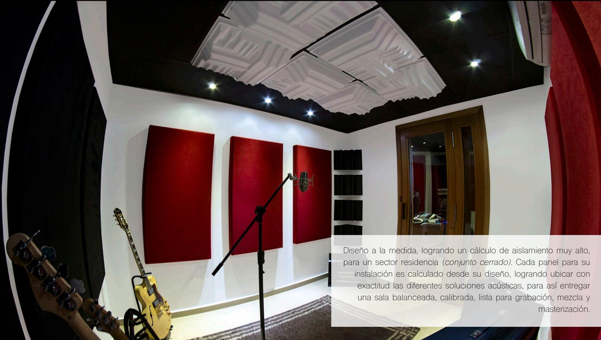
Diseño a la medida, logrando un cálculo de aislamiento muy alto, para un sector residencia (*conjunto cerrado*). Cada panel para su instalación es calculado desde su diseño, logrando ubicar con exactitud las diferentes soluciones acústicas, para así entregar una sala balanceada, calibrada, lista para grabación, mezcla y masterización.
